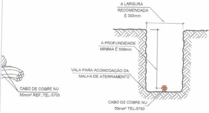
DETALHE DA VALA DA MALHA DE ATERRAMENTO
