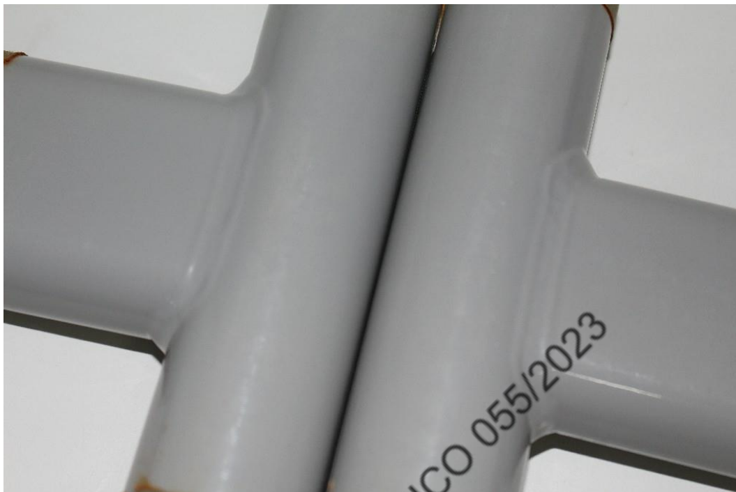
Amostra após 3000 horas de exposição.
