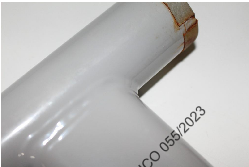
Amostra após 3000 horas de exposição.
