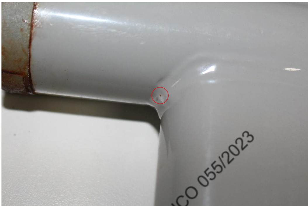
Amostra após 3000 horas de exposição. Destaque do ponto de corrosão vermelha observado na região de solda do CP 1.
