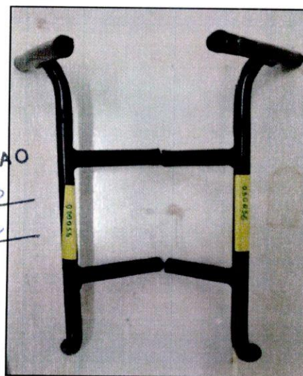
Foto 6 – Cadeira seccionada após o ensaio
