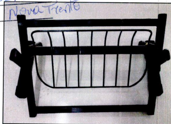
Foto 4 – Mesa seccionada após o ensaio
