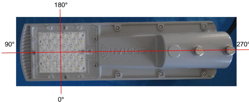
Foto 4 - Eixos fotométricos utilizados
