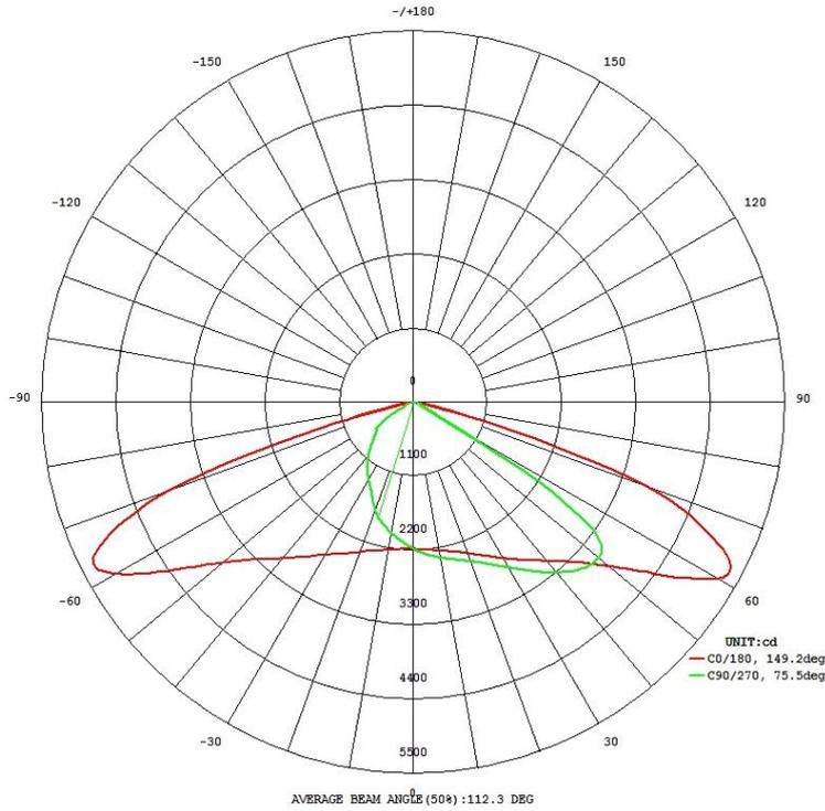
Figura 1 - Curva de distribuição de intensidade luminosa
