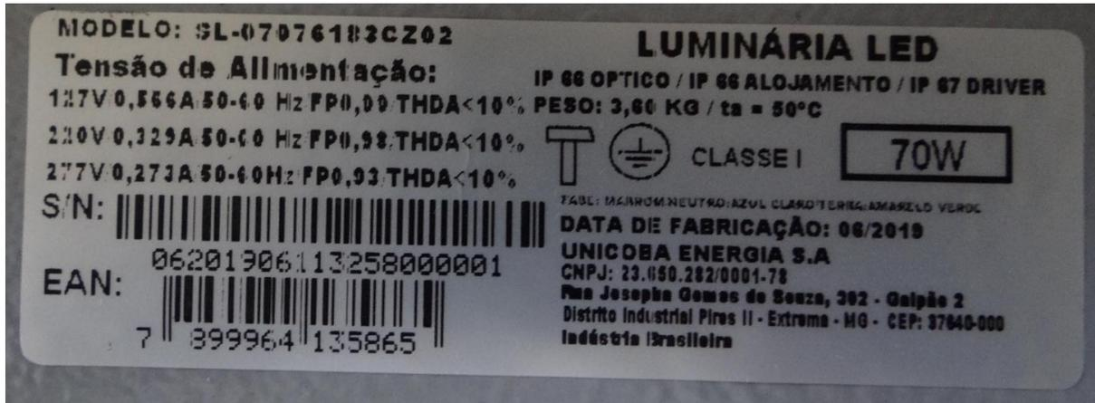
Foto 3 - Placa de identificação da amostra
