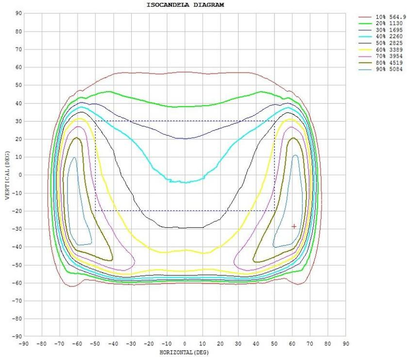
Figura 3 - Curva de distribuição de intensidade (isocandela)
