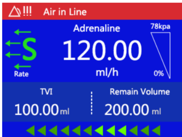
Figura 8-5 Alarme de ar na linha
