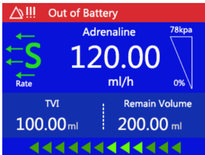
Figura 18-6 Alarme de falta de bateria
