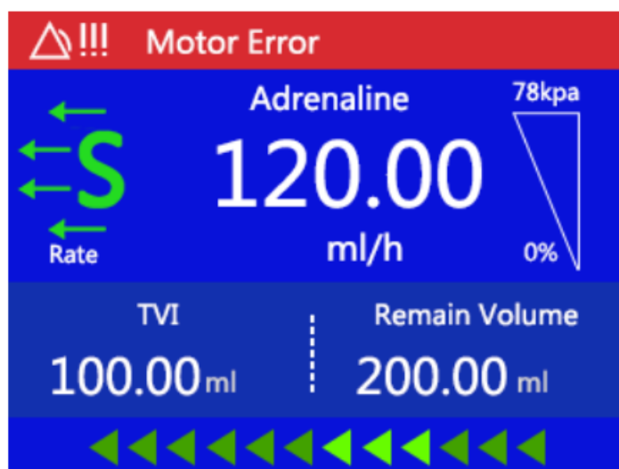
Figura 18-8 Alarme de erro no motor
