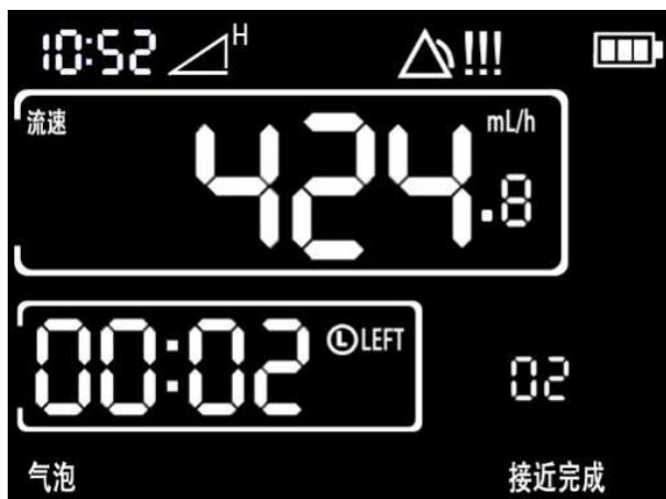
Figura 13-4 Alarme de ar na linha
