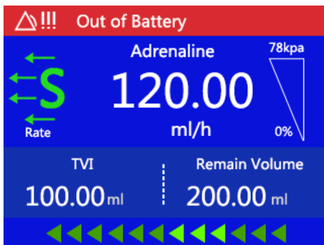
Figura 8-6 Alarme de falta de bateria
