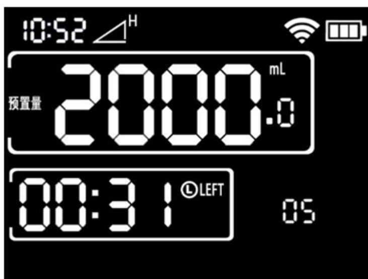
Figura 12-3-2 Configuração do volume de infusão
