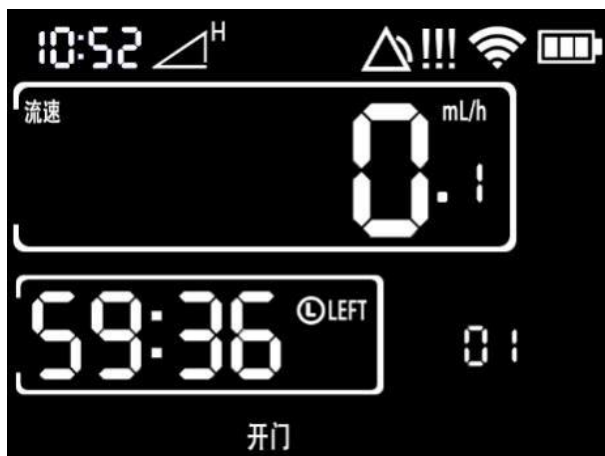
Figura 13-1 Alarme de abertura da porta.
