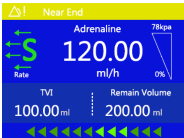
Figura 8-11 Alarme de Infusão Próxima do Fim
