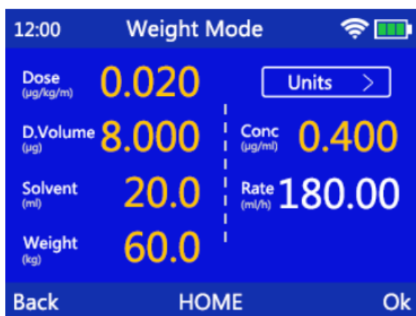
Figura 17-14 Configuração de modo de peso corporal
