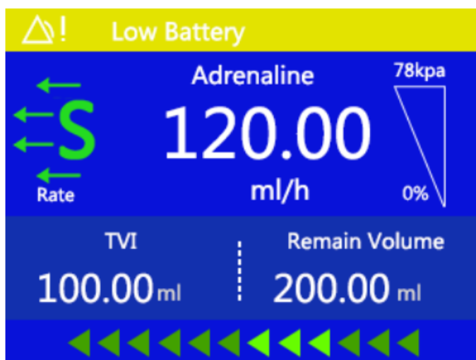
Figura 18-10 Alarme de bateria fraca
