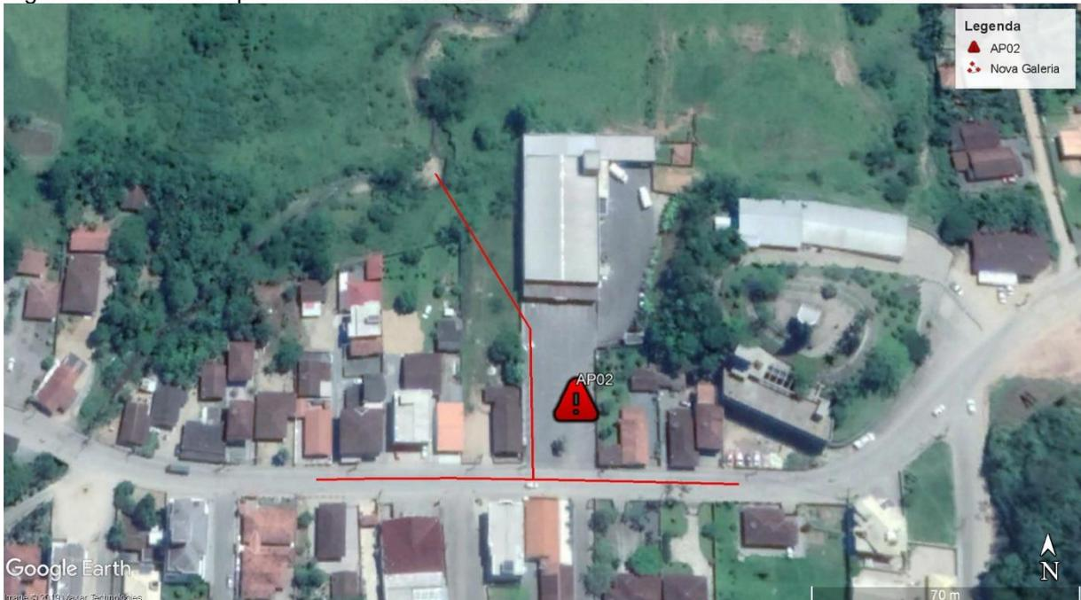
**AP 03 – Área Problema 03 – Rua Ivo Ceccato:** Nesta área sugere-se que a tubulação de drenagem existente seja substituída por galeria com diâmetro adequado, que considere as vazões provenientes dos cursos d'água à montante. Esta deverá ser interligada a nova galeria implantada na Rua Alferes (alternativa de solução da AP02).
