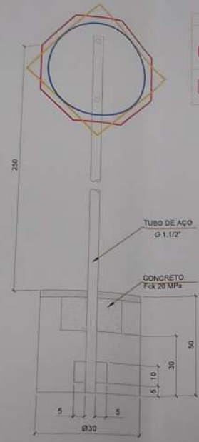
DETALHE DE SUPORTE PARA FIXAÇÃO DE PLACAS
